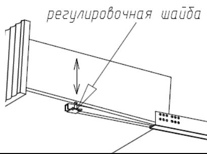
4. При желании, закрепите ящик к направляющим саморезами. ВАЖНО! Во избежание повреждения боковины ящика рекомендуется предварительно просверлить отверстие для вкручивания самореза.
