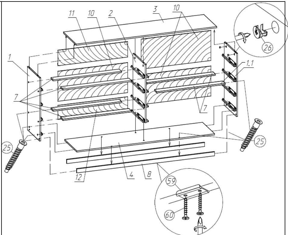
**Схема соединения скрепками (поз.67)
