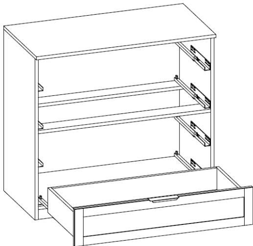
1. При установке ящика скобы выдвижных механизмов введите в отверстия на задней стенке ящика.
